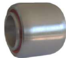
BUJE PARA MUELLE KENWORTH MOD. T880 (2017) EXT. 2 27/32" INT. 31/32" LG. 2 27/32"
