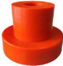
BUJE PARA BISAGRA DE COFRE/ BUJE AISLADOR OD: 1 3/4" ID: 17/32" LG: 1 3/8" OD<: 1 5/32"
