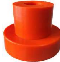
SOPORTE PARA CABINA OD: 2 1/2" OD<: 1 19/32" ID: 5/8" LG: 2"
