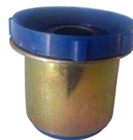
BUJE P/ MUELLE TRASERA. ISUZU NPR EXT. 40.2 mm INT. 16.2 mm
