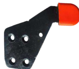
SOPORTE IZQUIERDO PARA COFRE INTERNATIONAL TRUCK LG: 8 3/16" WD: 6 15/32" H: 213/32" HO: 29/64" TK: 5/16"
