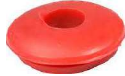
GOMAS PARA MANITAS, SELLO P/CONEXIÓN DE AIRE OD: 1 5/8" ID: 5/8" TK: 3/8"
