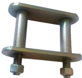
COLUMPIO NISSAN PERNO 20MM
