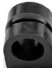
GOMA BARRA ESTABIL.. TSURO I NISSAN 92- EXT. 33MM INT. 21MM LG. 30MM
