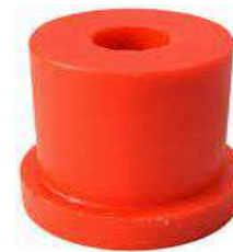
BUJE DELANTERO PERNO NISSAN EXT. 1 5/8" INT. 5/8"
