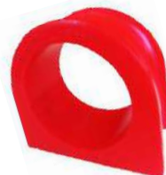
SOPORTE CAJA DE DIRECCIÓN TOYOTA TACOMA (00-07) EXT. 68MM INT. 56MM ALT. 75MM
