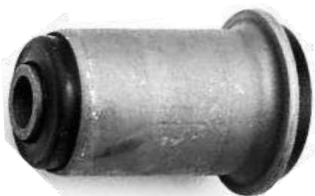
BUJE P/HORQUILLA INFERIOR DODGE D250 (1972-1993) EXT. 54.4MM INT. 19.3MM LG. 85MM
